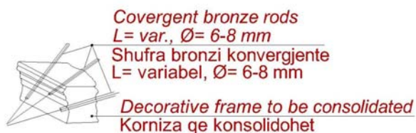
Fig. 4.154 Detaj i konsolidimit te kornizave.
