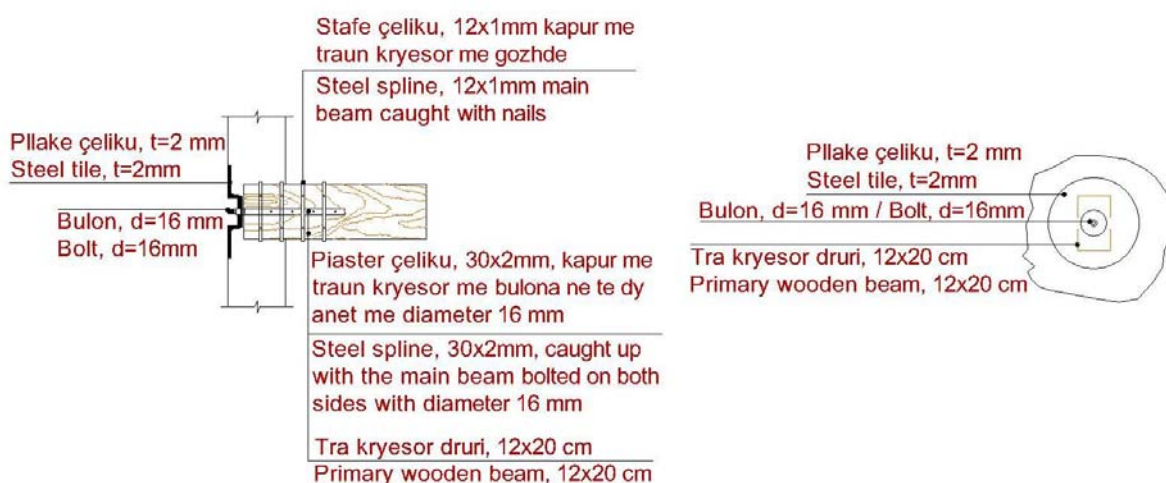
Fig. 4.165 Detaj i konsolidimit te soletave te drurit.
