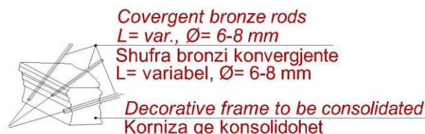
Fig. 4.154 Detaj i konsolidimit te kornizave.
