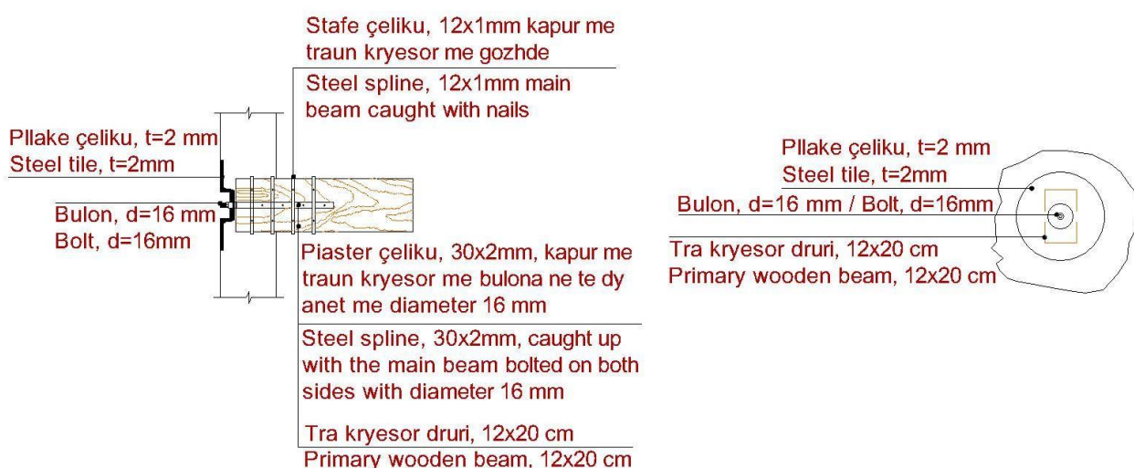
Fig. 4.165 Detaj i konsolidimit te soletave te drurit.
